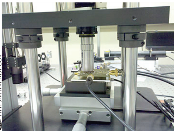
Микроскоп с наноскала, на който се прави тест на MEMS
